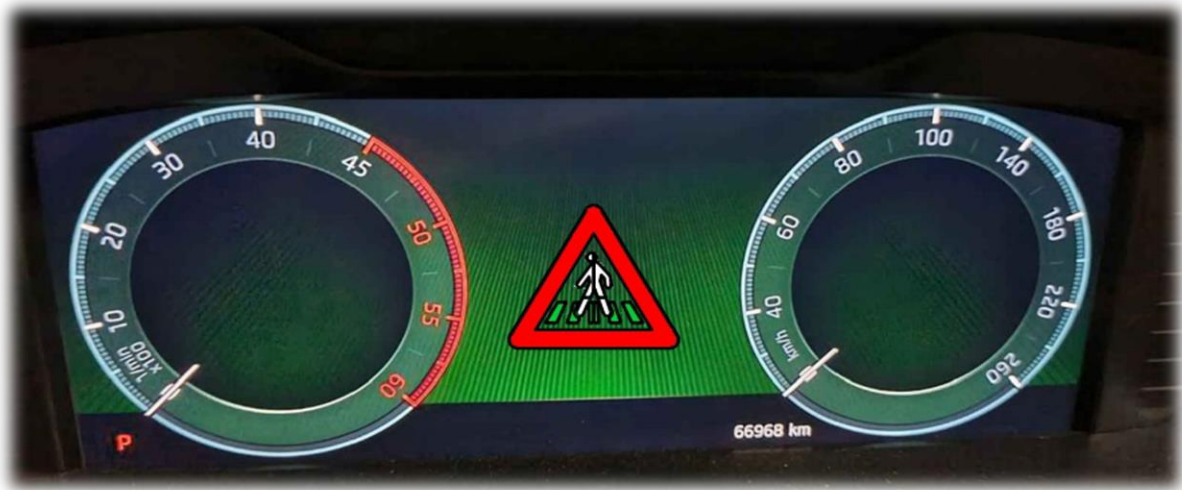
Slika 5. Idejni prijedlog svjetlosnog simbola na instrument ploči vozila
