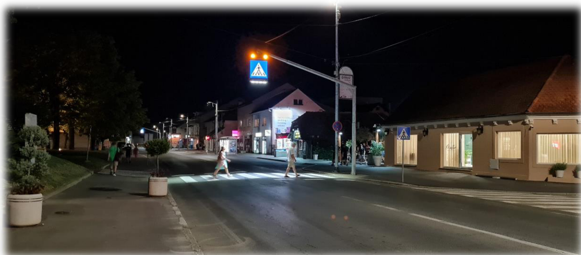
Slika 24. Iscrtni pješački prijelaz vizualno označen upotrebom svjetlosnog signala
