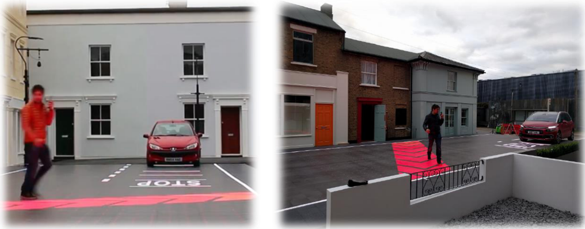
Slika 27. Starling Crossing, prikaz putanje pješačkog prijelaza koji nije na okomitoj putanji [12]
