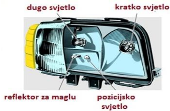
Slika 12. Reflektor slobodnog oblika
