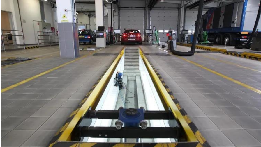
Slika 7. Prikaz kanala za pregled donjeg postroja vozila na tehničkom pregledu. Izvor: [11]
