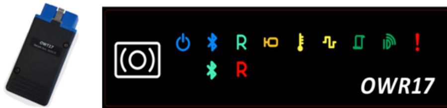
Slika 10. OBD uređaj i uređaj za spajanje s električnim sučeljem vozila. Izvor: [11]
