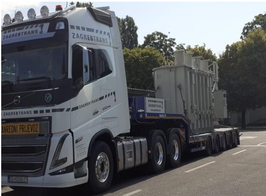
Slika 134. Prijevoz rashladne baterije Izvor: ZAGREBTRANS d.o.o. 2022.
