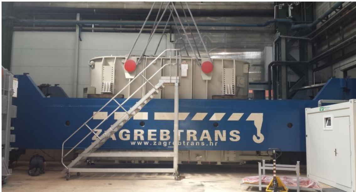
Slika 10. Ukrcanj transformatora Izvor: ZAGREBTRANS d.o.o. 2022.
