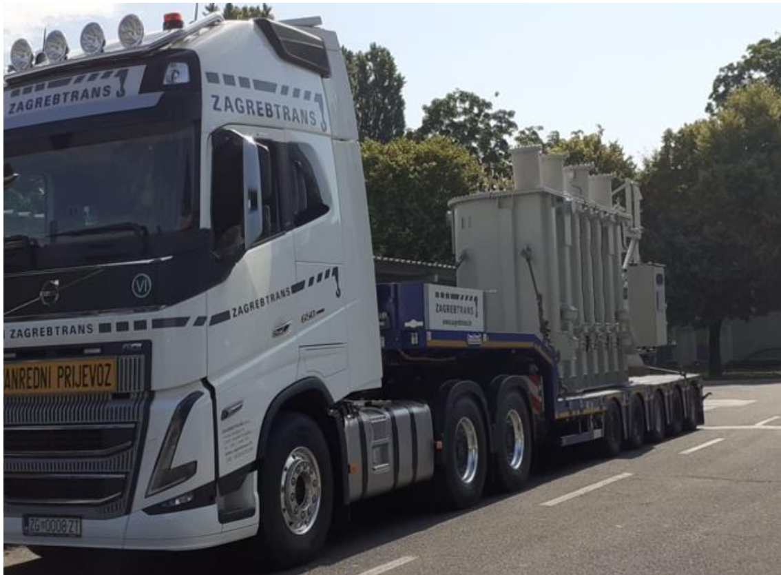
Slika 134. Prijevoz rashladne baterije Izvor: ZAGREBTRANS d.o.o. 2022.
