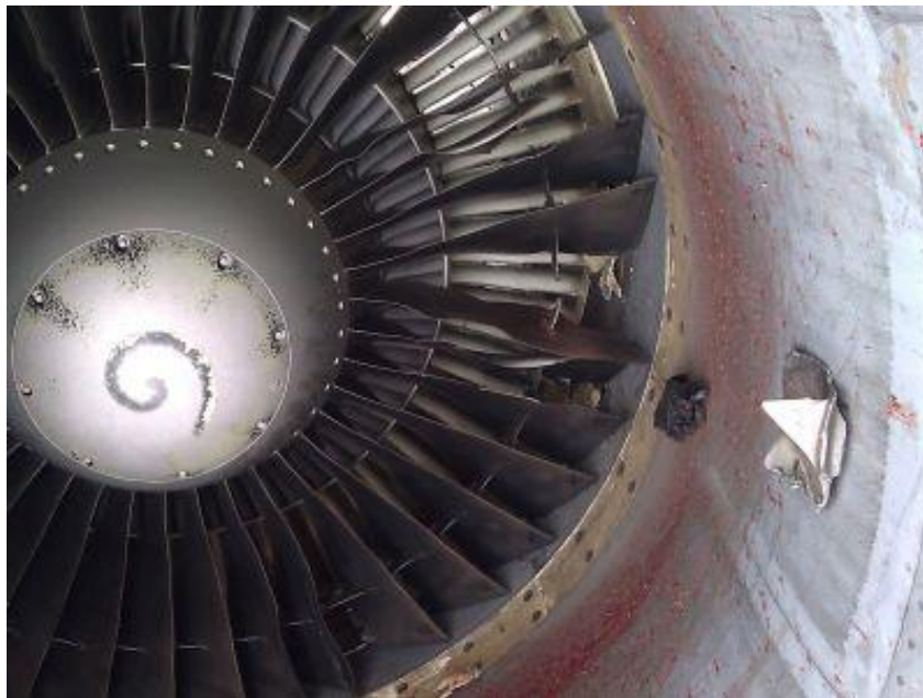
Slika 4. Oštećenje lopatica ventilatora
