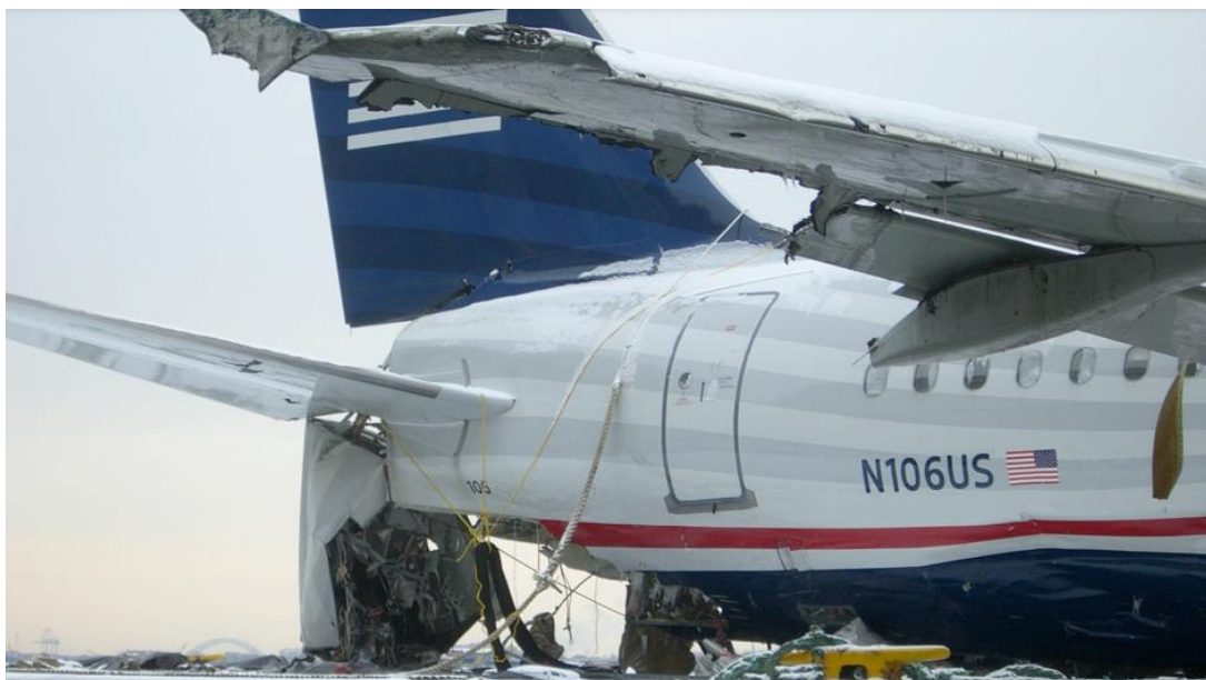
Slika 9. Prikaz oštećenja stražnjeg dijela trupa
