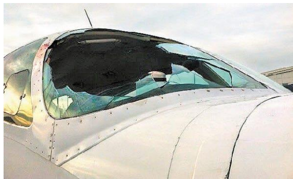
Slika 6. Proboj ptice kroz vjetrobransko staklo
