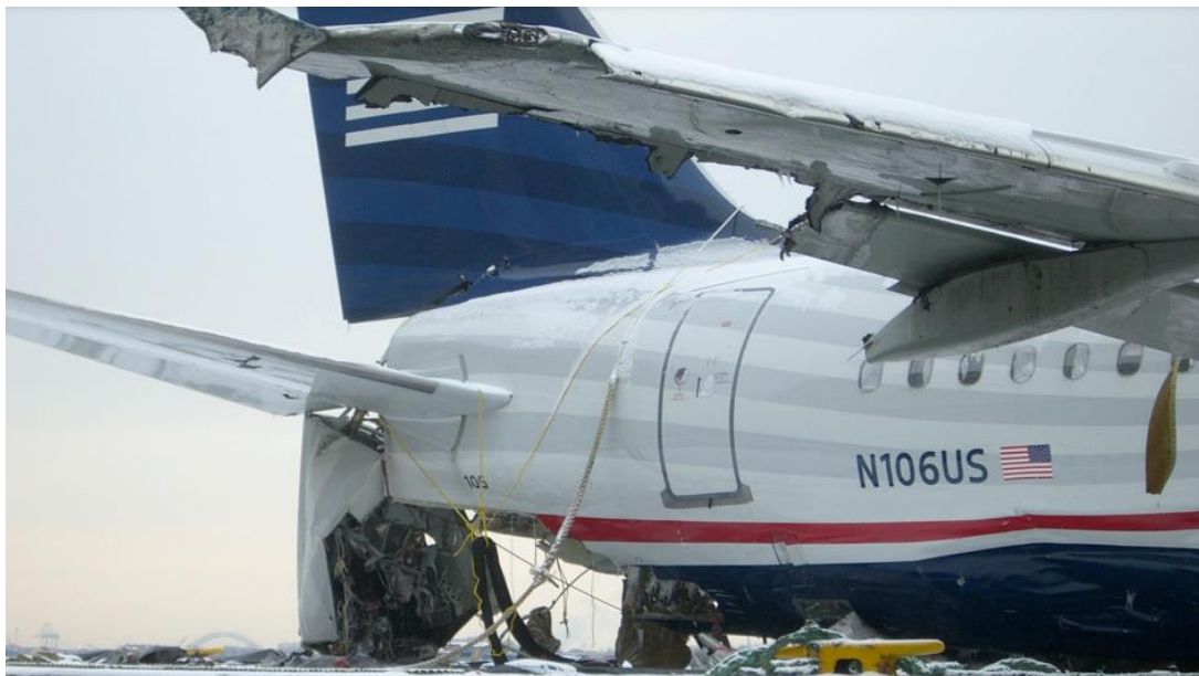
Slika 9. Prikaz oštećenja stražnjeg dijela trupa
