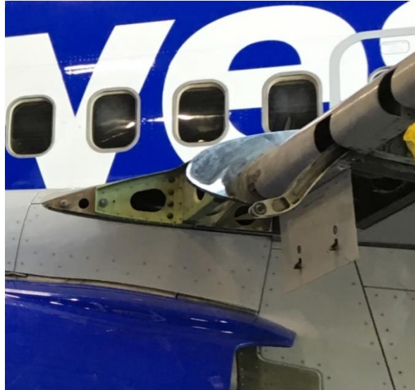
Slika 5. Oštećenje krila zbog udara ptice
