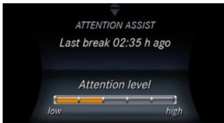
Slika 7. Zaslon u vozilu MB Truck - Attention Assist [16]
