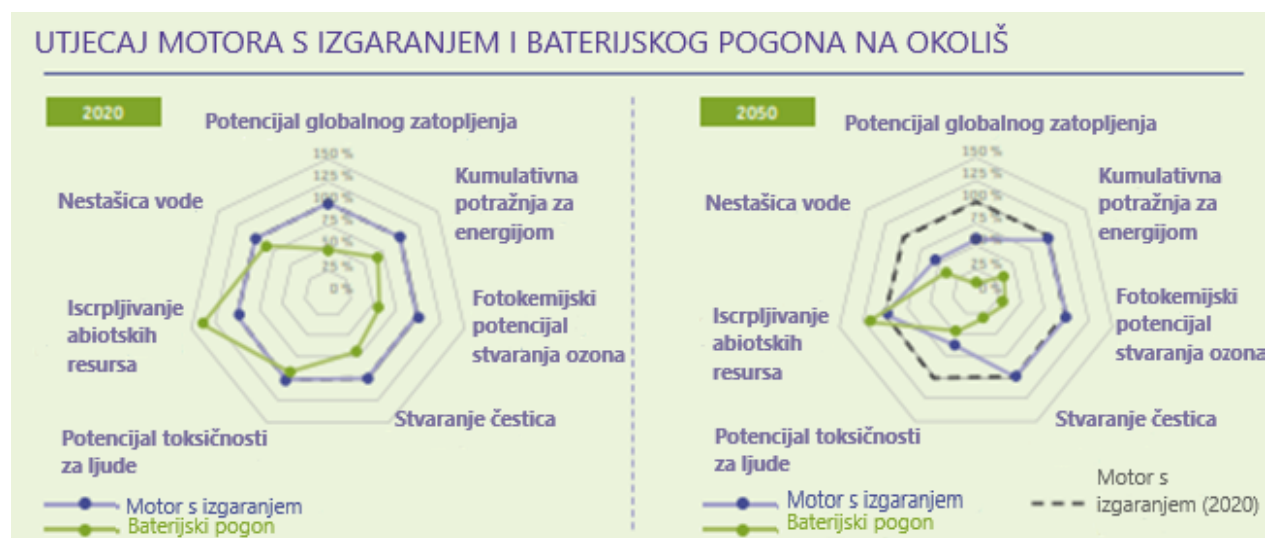
Slika 7. Usporedba utjecaja na okoliš vozila s unutarnjim izgaranjem i električnih vozila 2020. i 2050.godine, [20]
