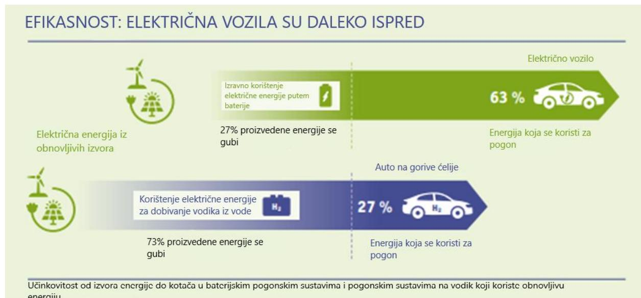
**Slika 10.** Prikaz efikasnosti od izvora do kotača u baterijskom pogonu i pogonu na vodik, [20]
