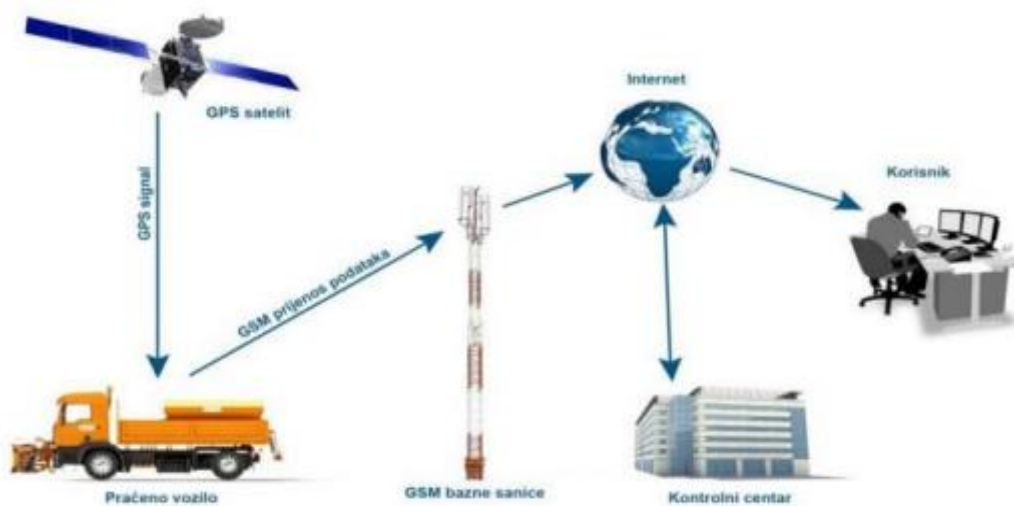
Slika 10. Praćenje vozila primjenom GPS i GPRS tehnologije
