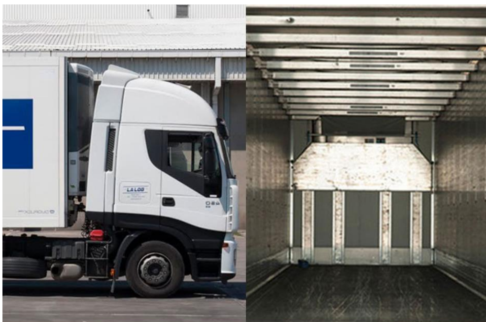
Slika 7 Hladnjača s dvostrukim podom
