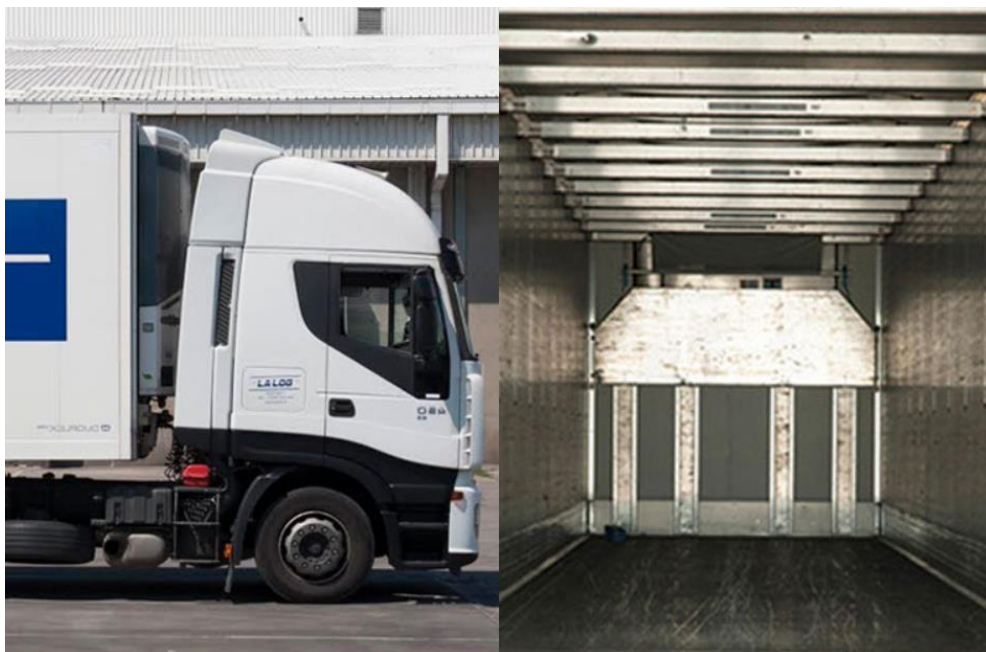
Slika 7 Hladnjača s dvostrukim podom
