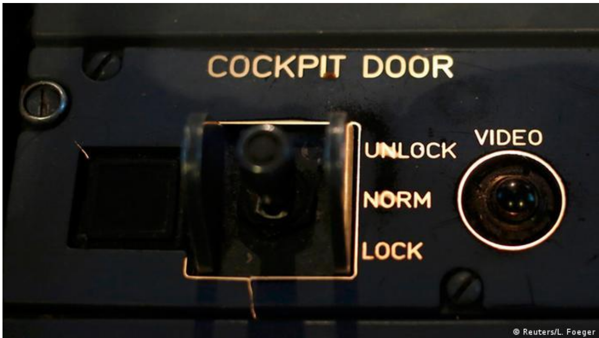
Slika 21. Upravljanje neprobojnim vratima u pilotskoj kabini
