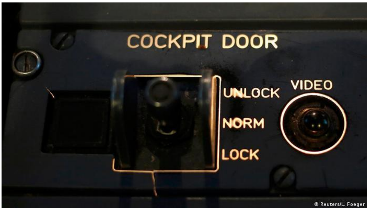
Slika 21. Upravljanje neprobojnim vratima u pilotskoj kabini
