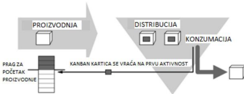
Slika 11. Kanban kartice koje označavaju početak proizvodnje, [19]
