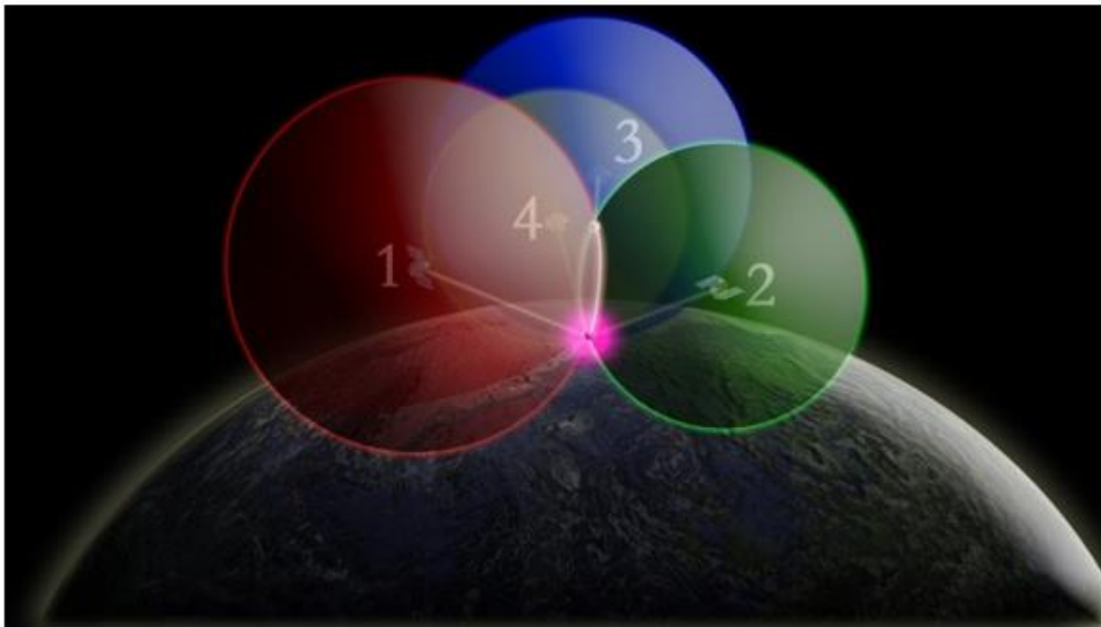
Slika 22. Domet i presjek četiri satelita, [20]
