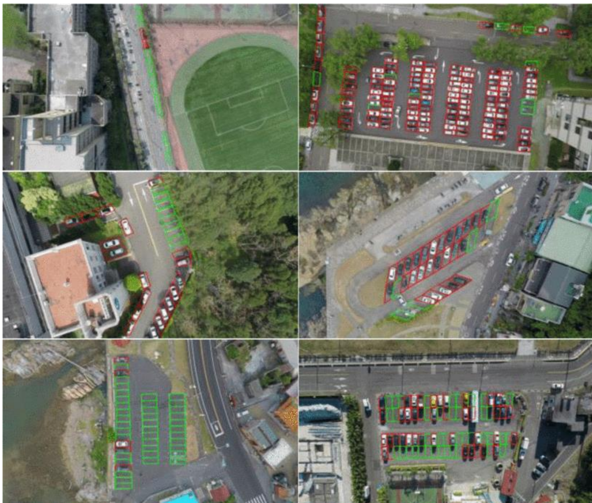
Slika 15. Nadzor parkirališta primjenom bespilotne letjelice
