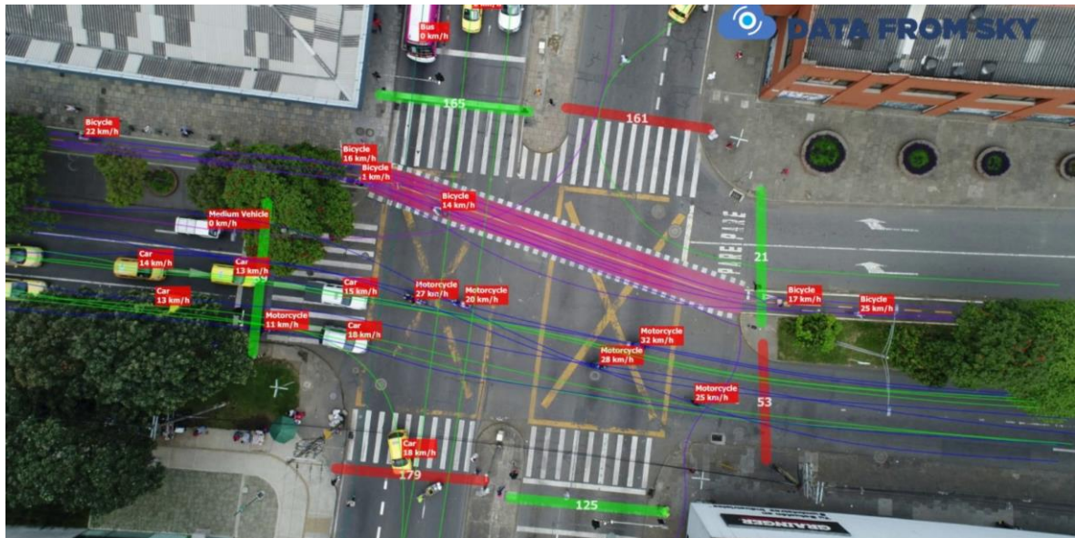
Slika 12. Obrada video podataka prikupljenih bespilotnom letjelicom
