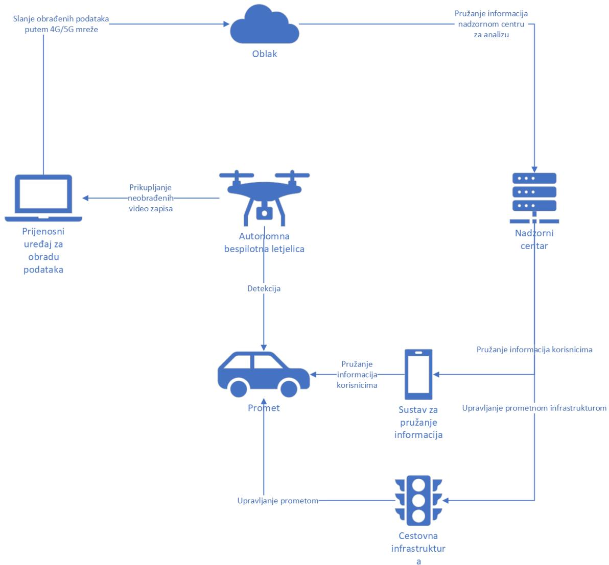
Slika 14. Prijedlog osnovnih komponenti ITS infrastrukture sa integriranim bespilotnom letjelicom
