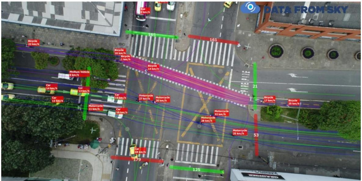
Slika 12. Obrada video podataka prikupljenih bespilotnom letjelicom
