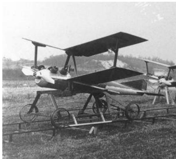
Slika 1. Kettering bug - prvi uspješni UAV torpedo
