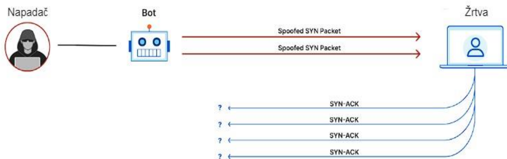
Slika 9: Prikaz primjera napada na protokol
