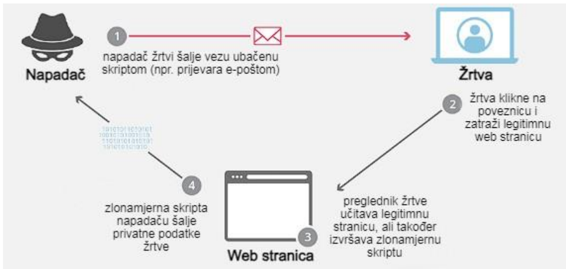
Slika 12: Prikaz primjera XSS napada
