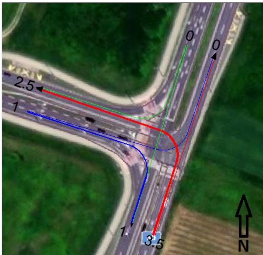
Slika 36. Prosječno prometno vršno satno opterećenje biciklističke staze na raskrižju Avenije Pape Ivana Pavla II – državne ceste D30 Izvor: autor uz pomoć programskog alata „AutoCAD“
