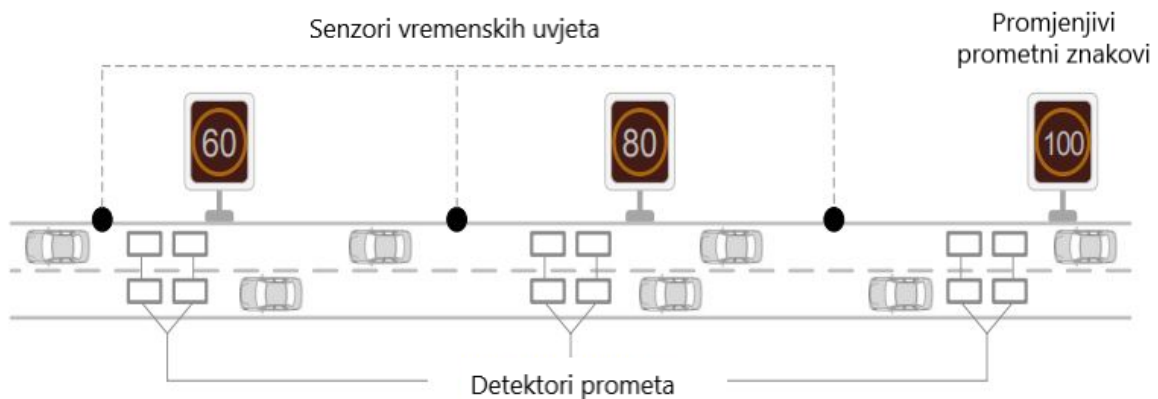
Slika 13. Prikaz sustava upravljanja ograničenjem brzine
