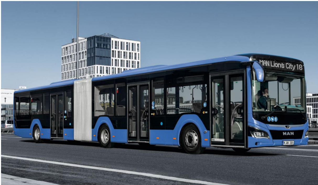
Slika 7. Zglobni troosovinski autobus za gradski promet - MAN Lion's City 18
