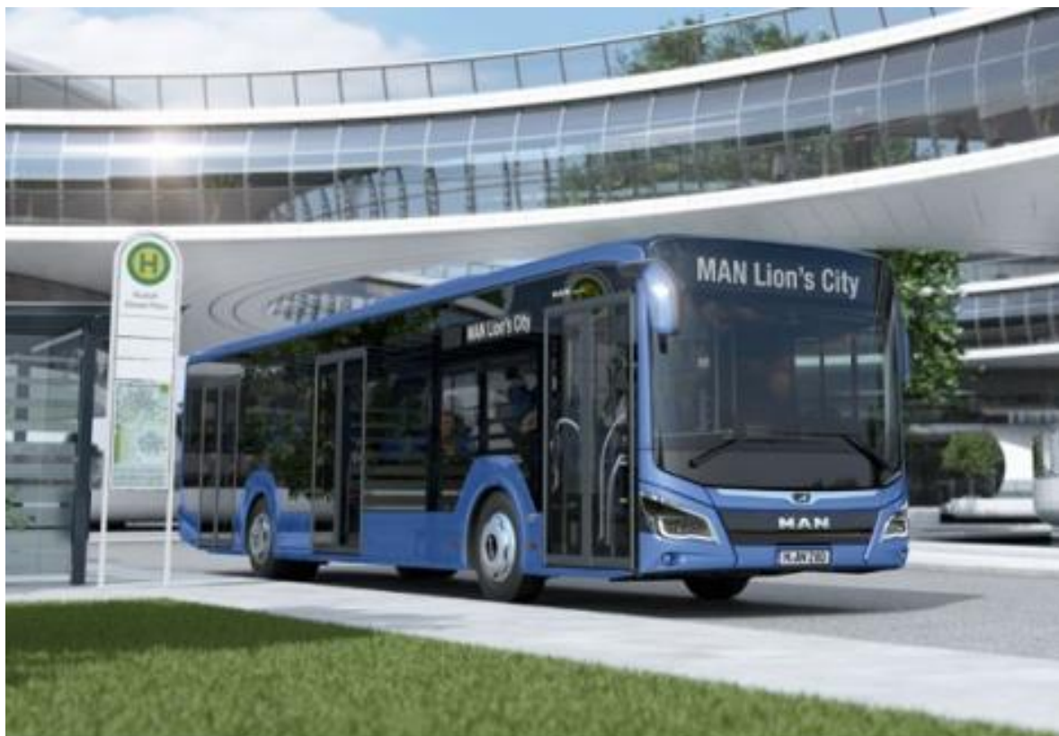
Slika 6. Standardni dvoosovinski autobus za gradski promet – MAN Lion's City
