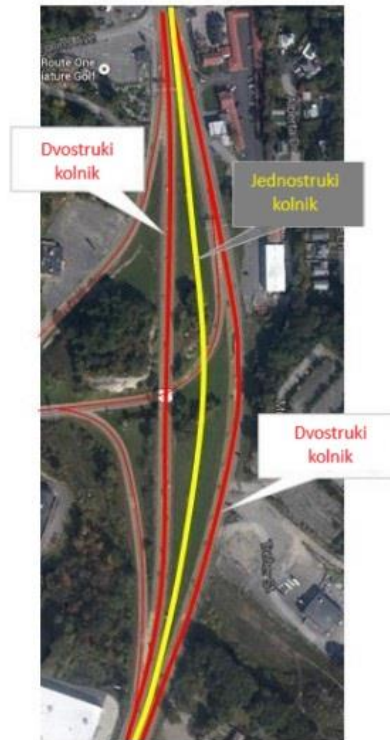
Slika 15. Razlika između jednostrukog i dvostrukog prikaza kolnika
