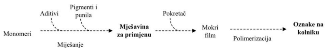
Slika 7. Shema procesa izvođenja termoplastike [signalizacija]
