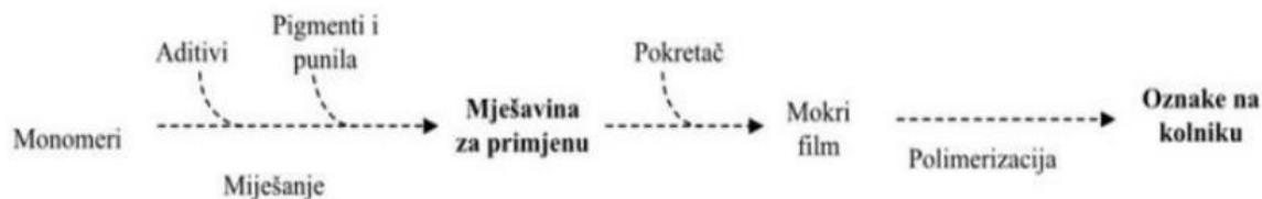
Slika 5. Hladna plastika postupak dobivanja oznaka [1]
