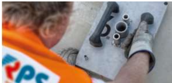
Slika 12. Primjer jedne od šablona za bušenje[16]
