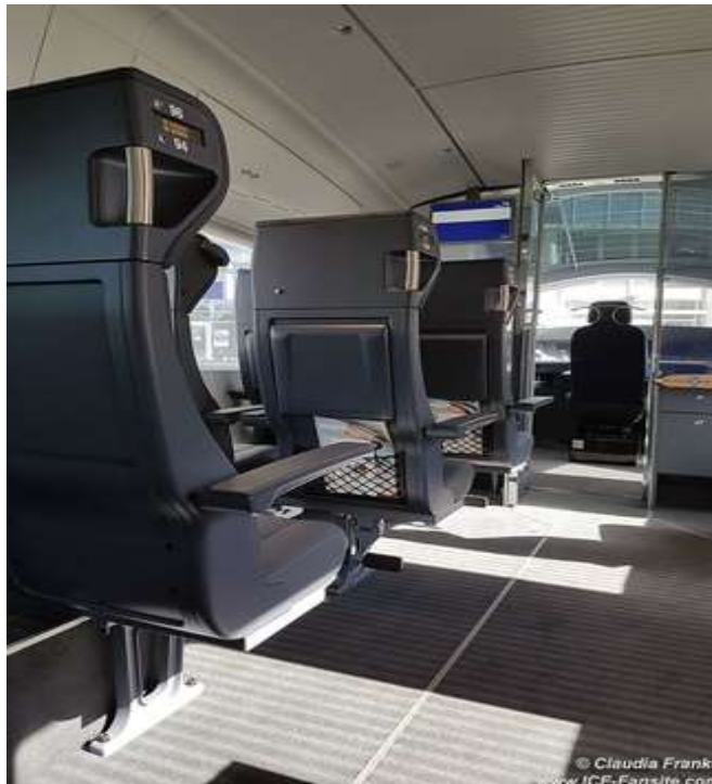
Slika 25. Stakleni zid između putnika i strojovođe, redizajn ICE 3 serije[37]
