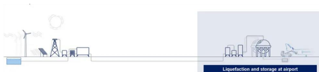
Slika 22. Prikaz strategije 2, vodik se proizvodi izvan zračne luke, doprema plinovodom i ukapljuje na zračnoj luci, [4]
