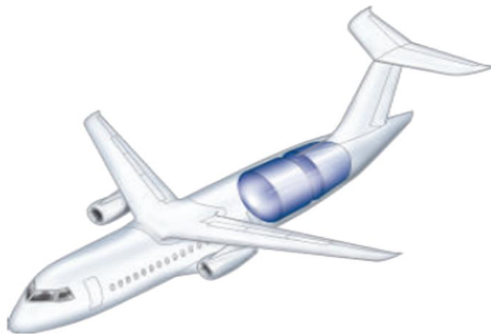
Slika 17. Položaj spremnika vodika kod regionalnih zrakoplova, [50]
