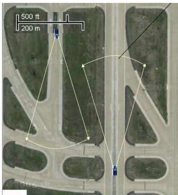
Slika 11. Polje skeniranja mobilnih radarskih sustava, [11]
