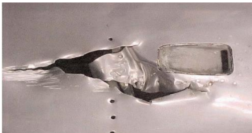
Slika 8. Oštećenje trupa zrakoplova, [10]
