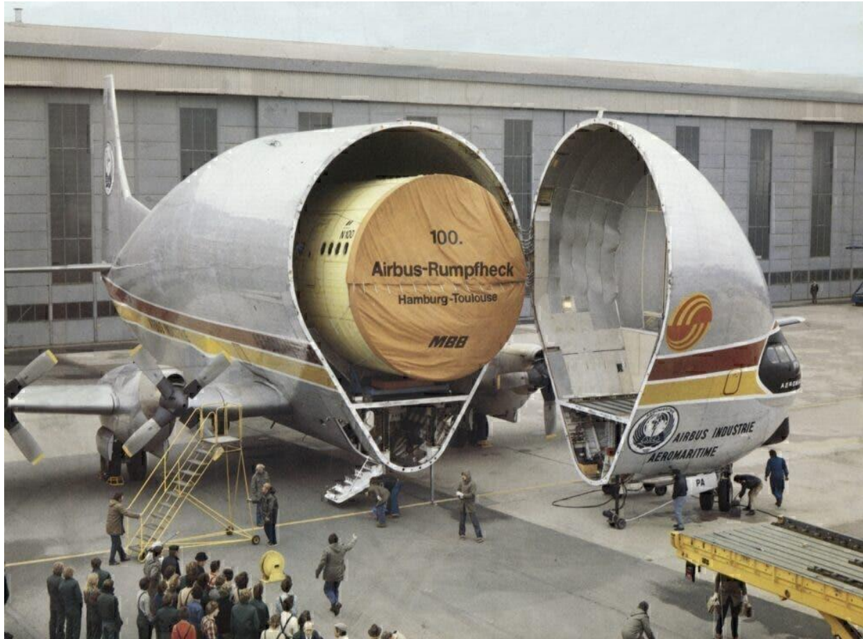
Slika 4. Primjer specifičnih tovarnih vrata Airbus Beluge
