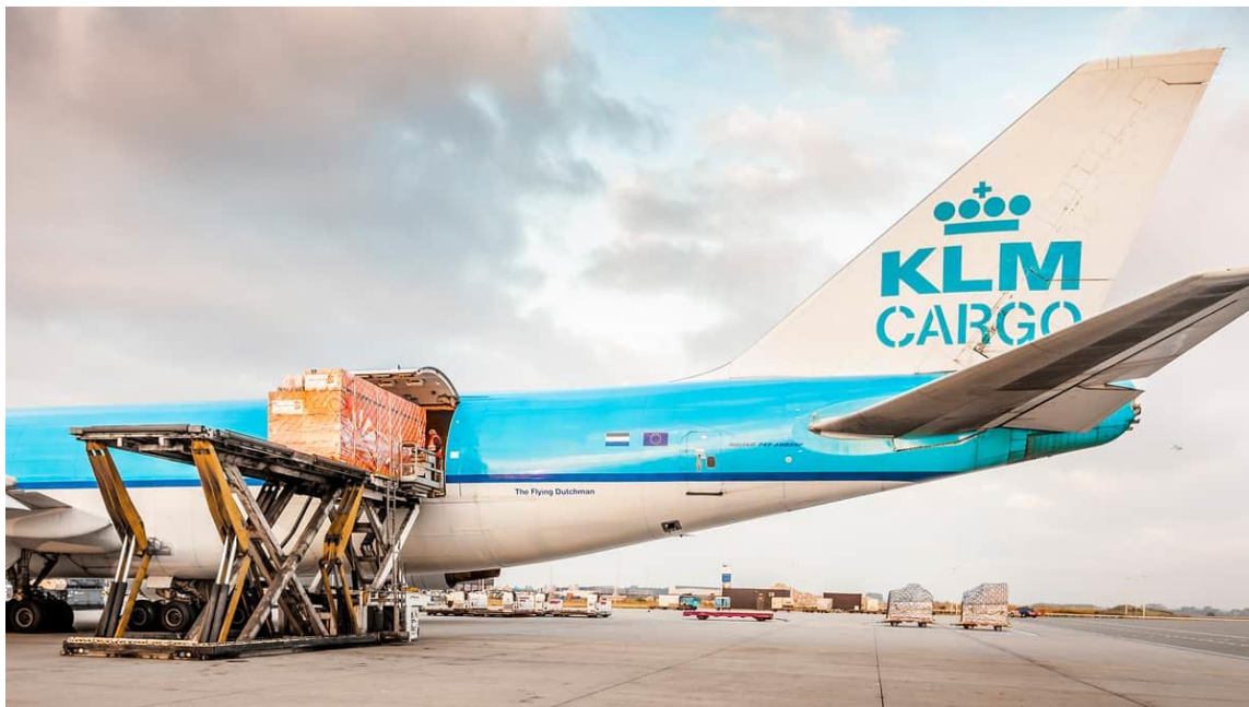
Slika 19. Primjer rampe za horizontalni ukrcaj tereta
