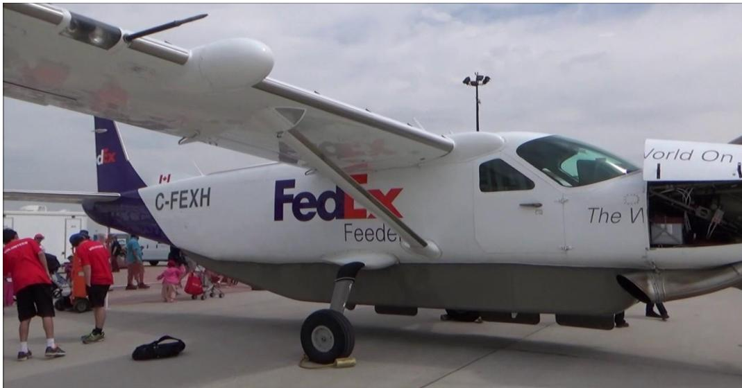
Slika 3. Primjer jednomotornog- turboprop zrakoplova kratkog dometa tvrtke FedEx
