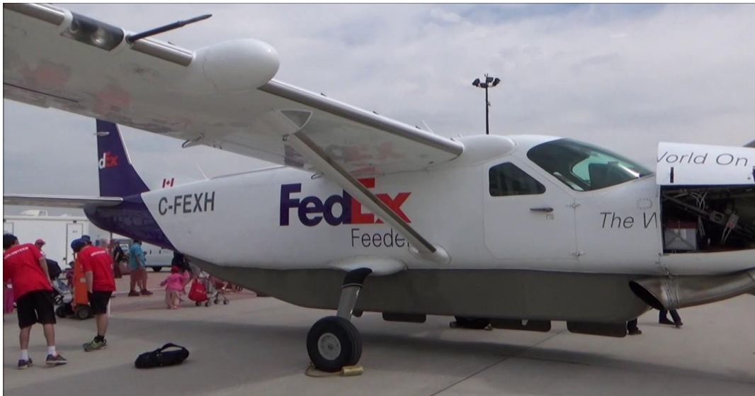
Slika 3. Primjer jednomotornog- turboprop zrakoplova kratkog dometa tvrtke FedEx Izvor: [11]
