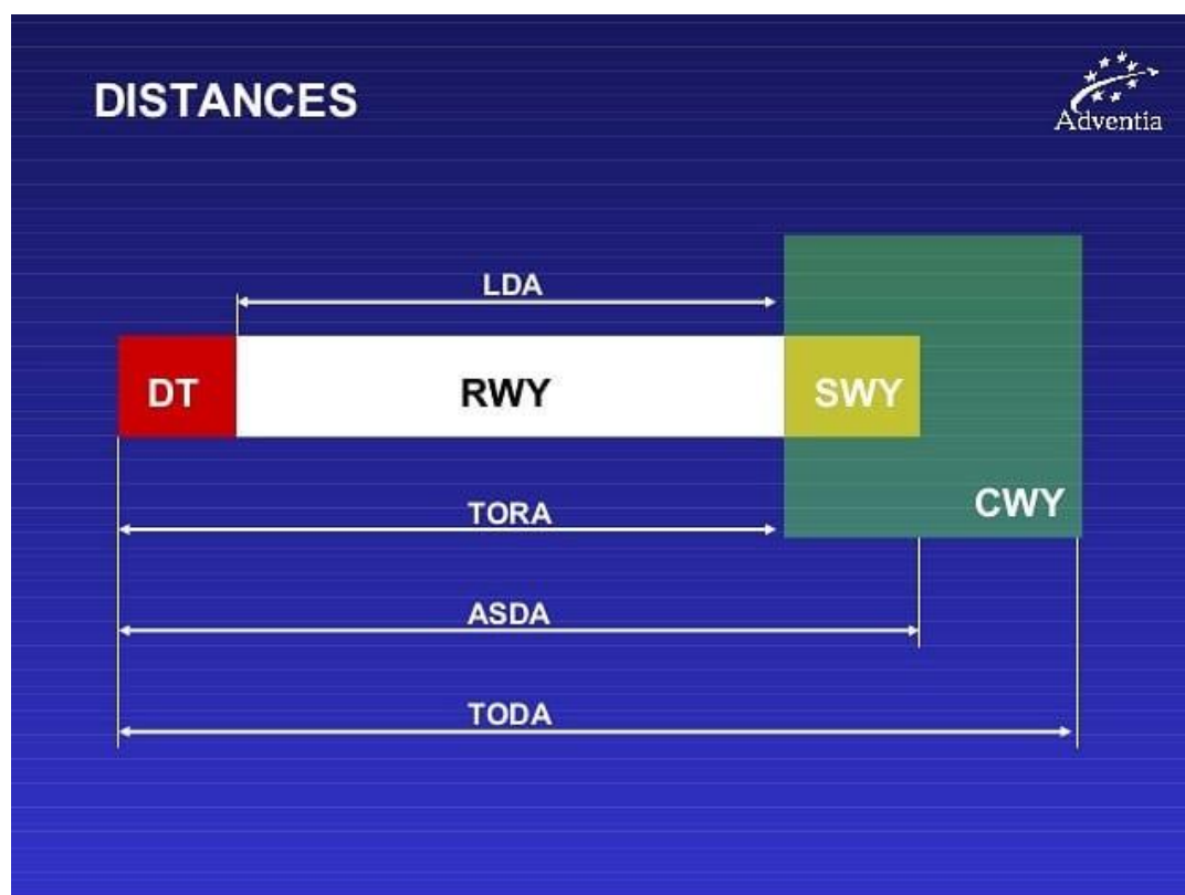
Slika 8. Karakteristične duljine uzletno-sletne staze, [12]
