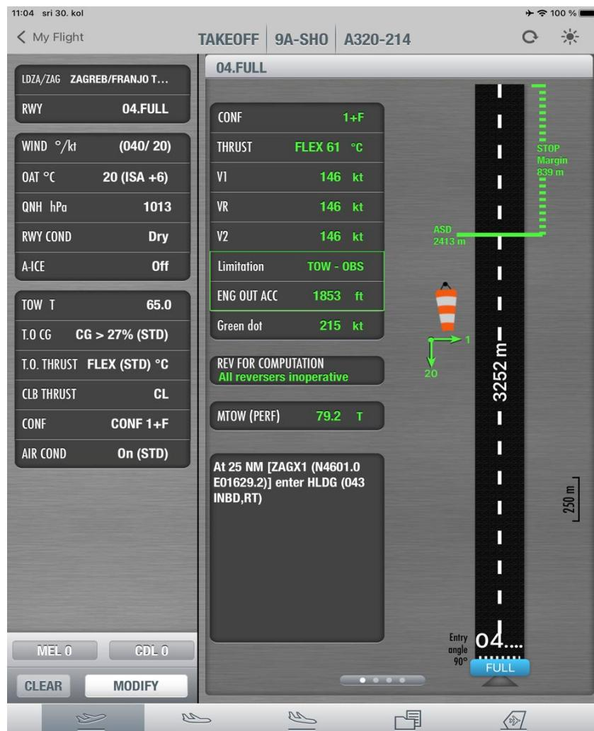
Slika 16. Primjer izračunate temperature i karakterističnih brzina, [14]
