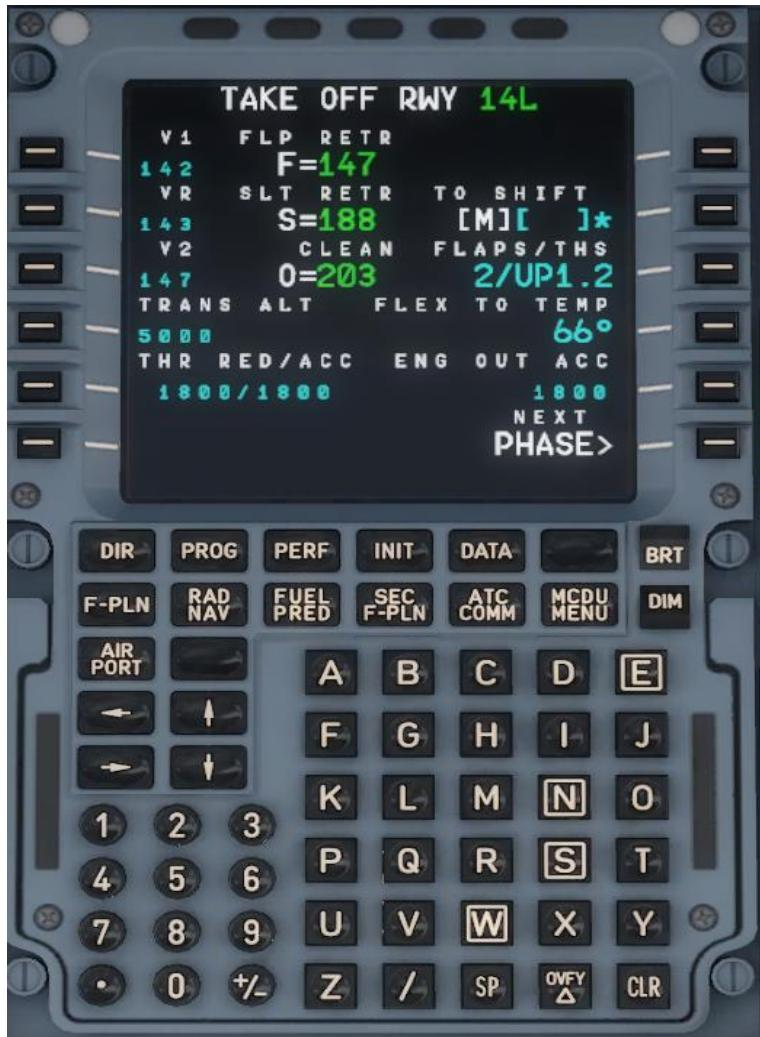
Slika 1. Prikaz stranice za performanse na MCDU u zrakoplovu Airbus A320, [2]
