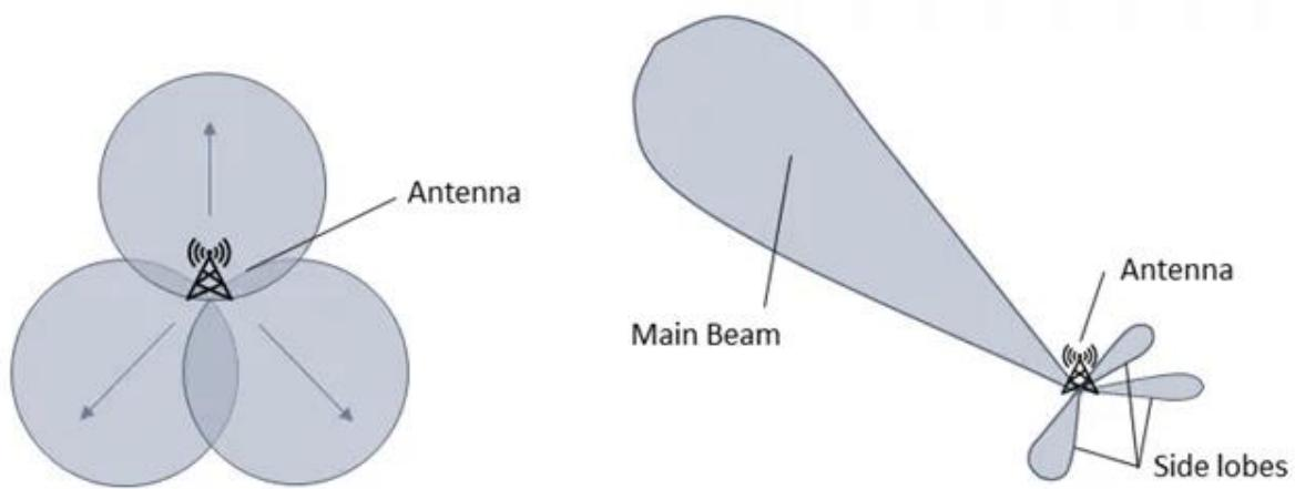
Slika 5: Zračenje antene beamforming tehnikom, [10]
