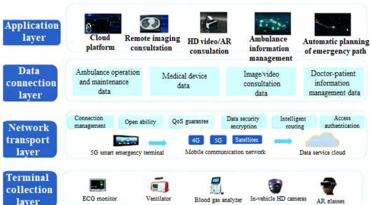
Slika 19. Cjelokupna struktura pred bolničke skrbi za hitnu pomoć temeljenu na 5G tehnologiji.
