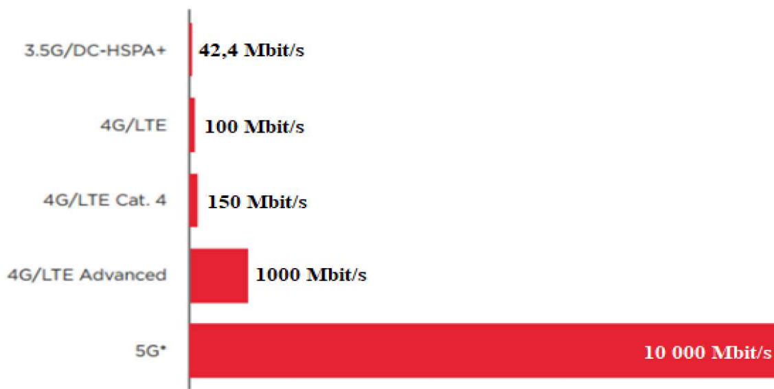
Slika 9. Usporedba brzina prijenosa podataka između 5G i ostalih
