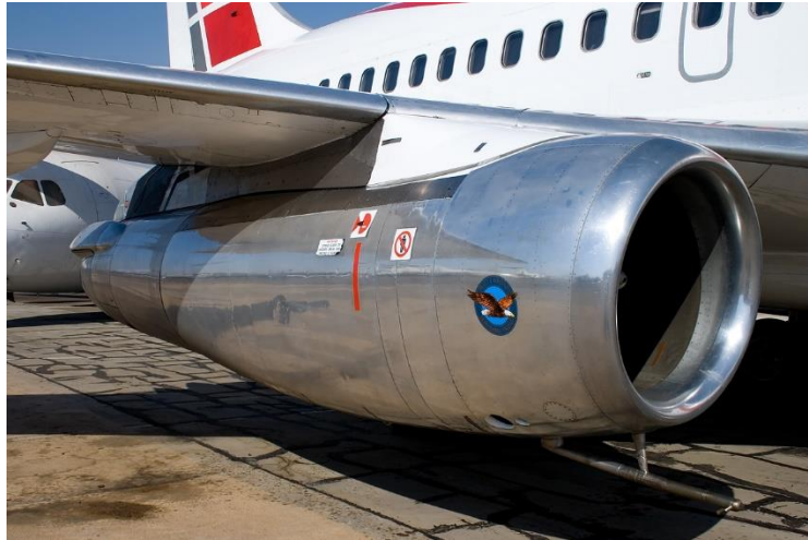
Slika 2. motor JT8D s opremom za šljunčane staze, [6]
