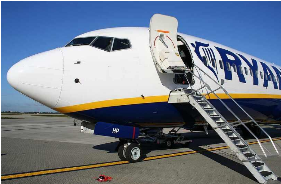
Slika 1. zrakoplov Ryanair-a s ugrađenim stepenicama, [5]
