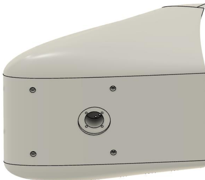
Slika 20: Prikaz ulaza za dinamometar unutar modela
