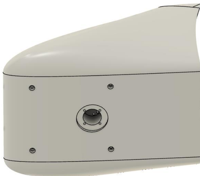
Slika 20: Prikaz ulaza za dinamometar unutar modela
