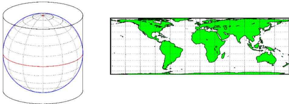
**Slika 2:** Položaj plašta cilindra u odnosu na sferu (*lijevo*) i konačan izgled projekcije (*desno*), [6]
