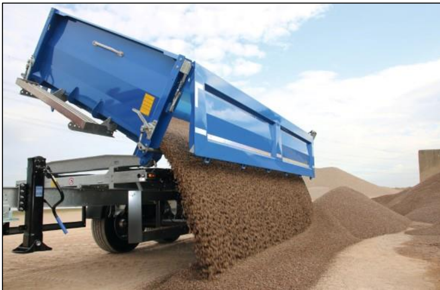
Slika 40. Prikaz bočnog podizanja utovarnog prostora dvoosovinske prikolice kiper konstrukcije SCHMITZ proizvođača marke Z.KI što olakšava upotrebu i omogućava veću produktivnost prijevoza sipke robe, [52]
