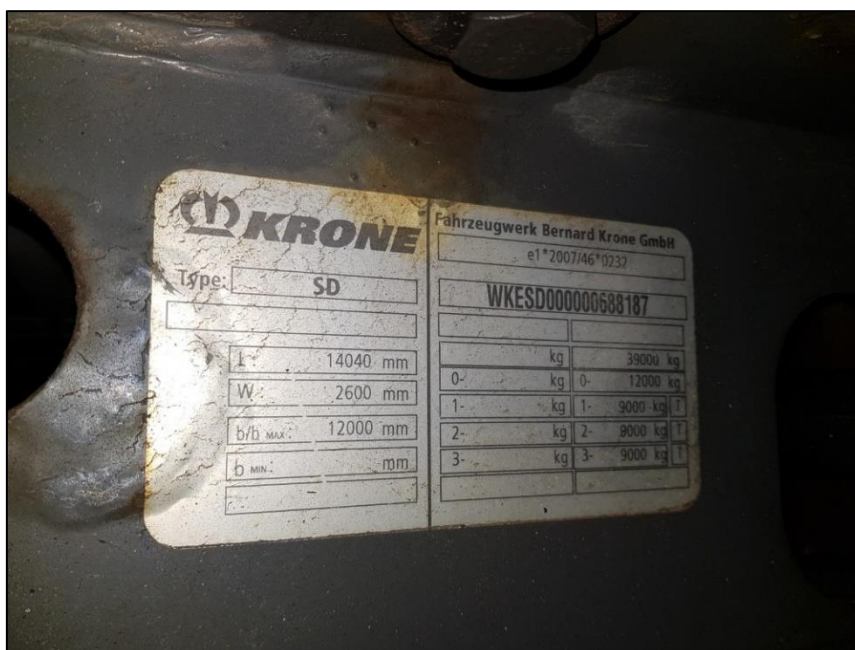
Slika 38. Eksploatacijske značajke troosovinske poluprikolice s temperaturnim režimom rada KRONE proizvođača marke Cool Liner koje su postavljene na prednjoj strani poluprikolice, [21]
