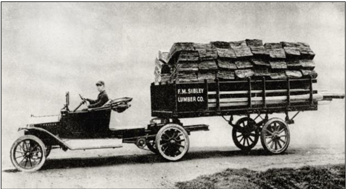
Slika 4. Prikaz vuče prve poluprikolice s automobilom Ford T, [30]
