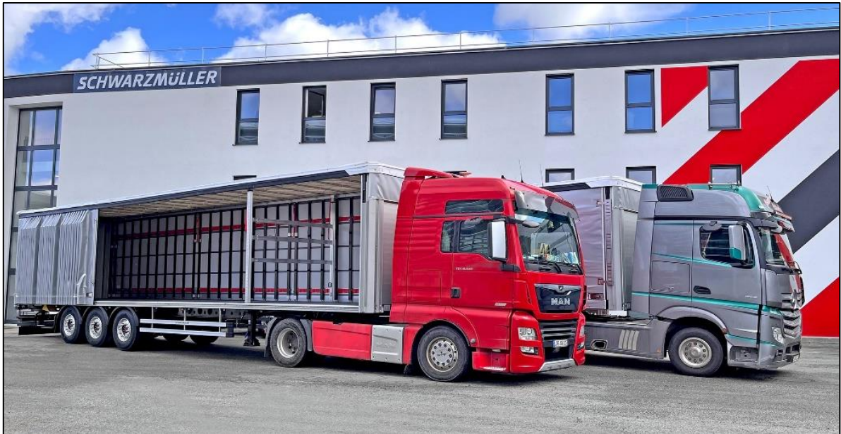
Slika 12. Standardni tegljači marke MAN TGX i MERCEDES – BENZ ACTROS kojima su prikopčane poluprikolice s 'brzim' ceradama SCHWARZMÜLLER proizvođača marke POWER LINE, [37]
