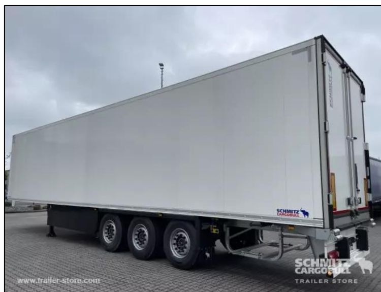
Slika 34. Vanjski izgled troosovinske poluprikolice s temperaturnim režimom rada SCHMITZ proizvođača marke FERROPLAST s trostrukim zatvaračima na stražnjem kraju poluprikolice, [20]
