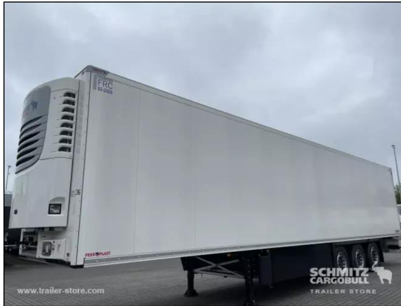
Slika 33. Vanjski izgled troosovinske poluprikolice s temperaturnim režimom rada SCHMITZ proizvođača marke FERROPLAST s rashladnim uređajem na prednjoj strani poluprikolice, [20]
