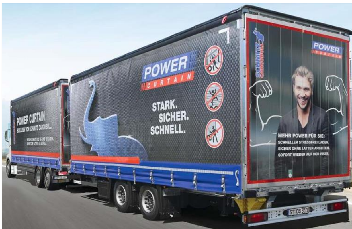
Slika 17. Vanjski izgled dvoosovinske prikolice s ceradom SCHMITZ proizvođača marke M.CS kod koje je položaj osovina na prikolici centralan, [40]
