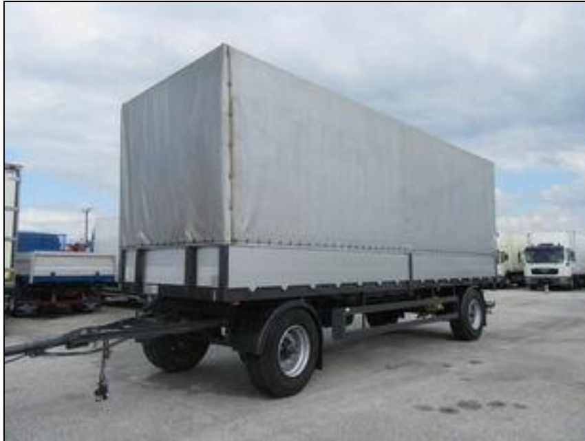
Slika 14. Vanjski izgled dvoosovinske prikolice s ceradom od SCHWARZMÜLLER proizvođača marke STANDARD kod koje je prva osovina upravljiva zbog lakšeg upravljanja u uskim područjima, [38]
