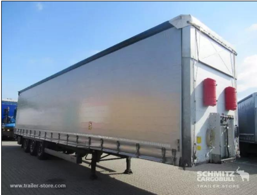
Slika 25. Vanjski izgled troosovinske poluprikolice s ceradom SCHMITZ proizvođača u mega izvedbi, [45]
