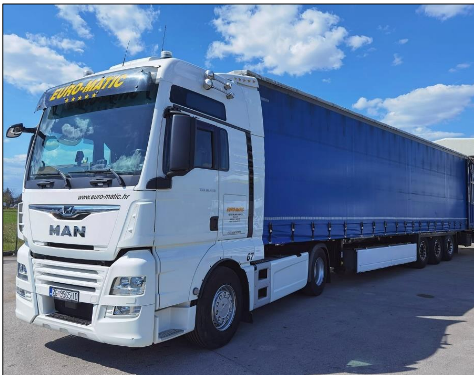
Slika 47. Prikaz standardne poluprikolice KRONE Profi Liner vučene tegljačem marke TGX, [54]
