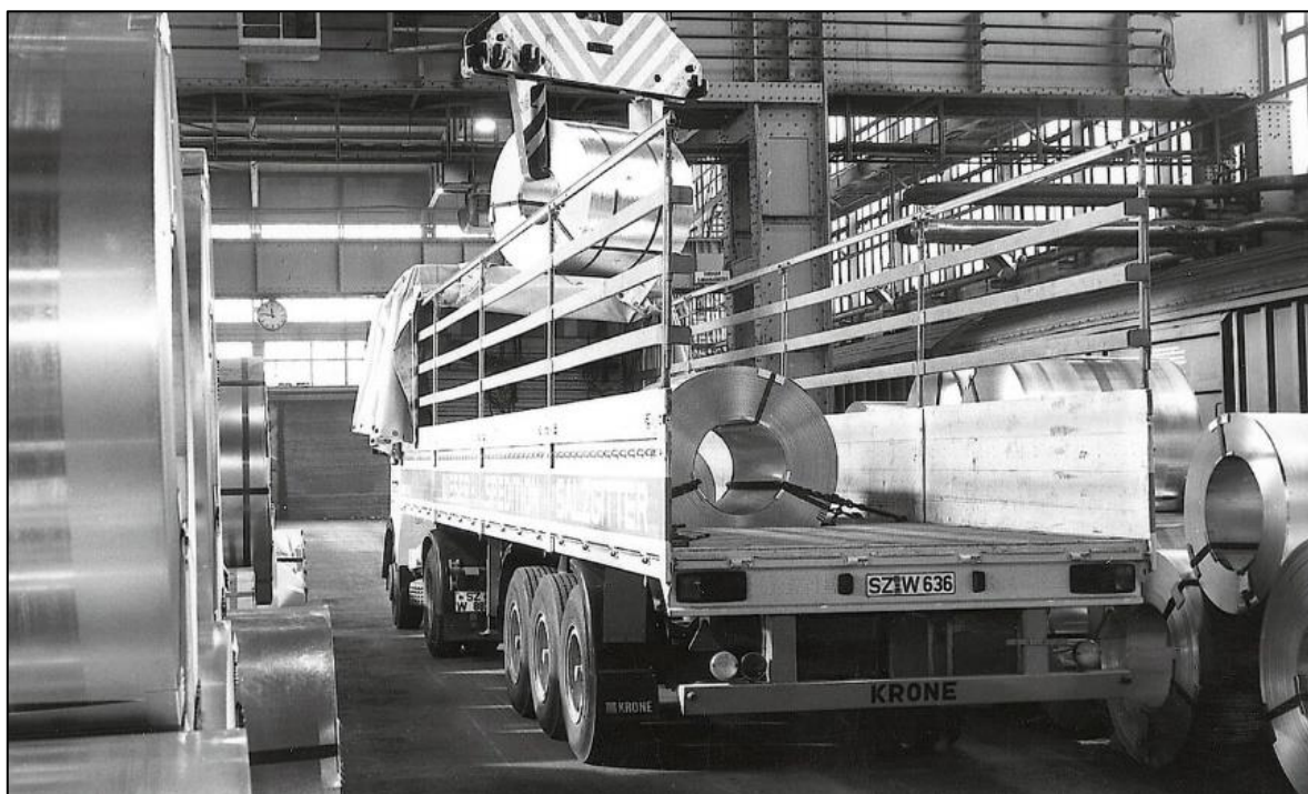
Slika 8. Prikaz poluprikolice KRONE Coil Liner koja je bila u početnoj primjeni tijekom 1970. – tih godina, [34]
