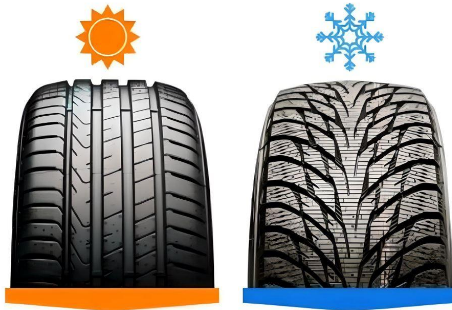
Slika 17. Gazna površina ljetnih i zimskih pneumatika
