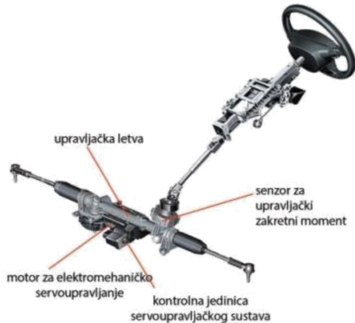
Slika 20. Električni servo upravljač smješten na upravljačkoj letvi
