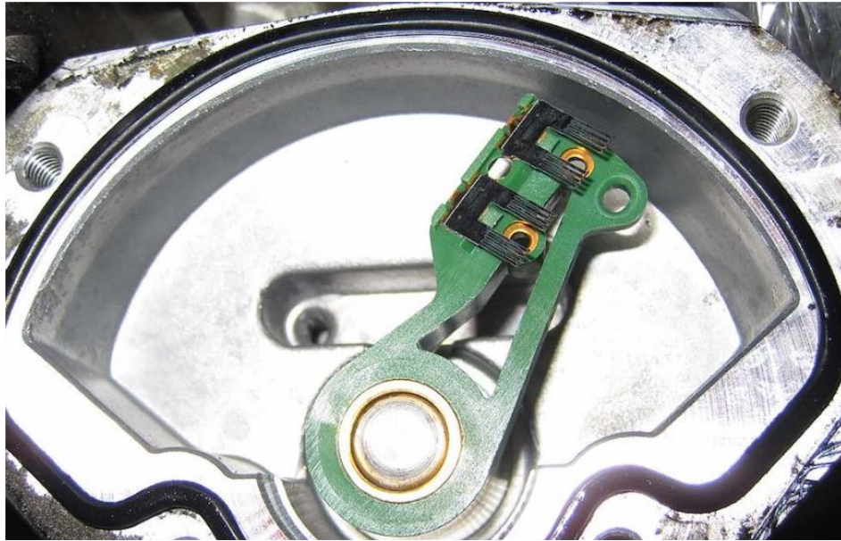
Slika 6 prikaz senzora položaja klapne gasa, [22]
