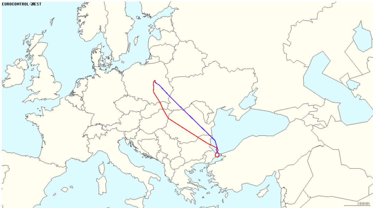
Slika 61. Putanja leta zrakoplova LOT135 prije (plavo) i nakon (crveno) zatvaranja zračnog prostora Ukrajine [18].
