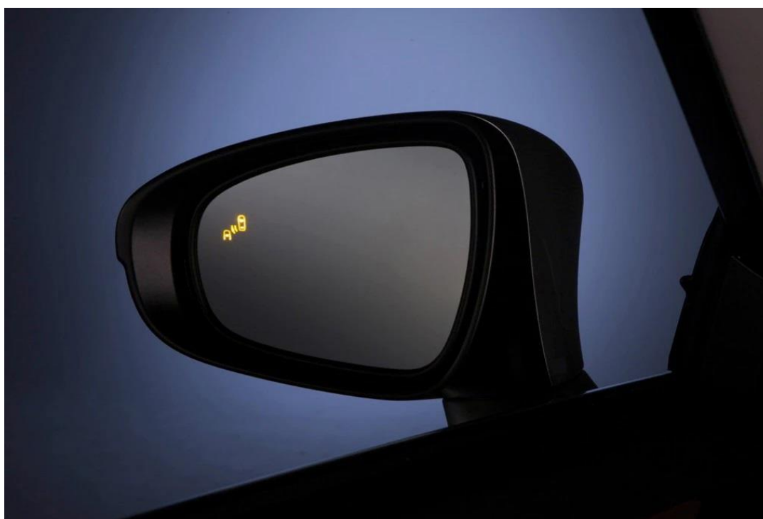
Slika 18. Svjetlosni signal na vanjskom ogledalu (retrovizor)
