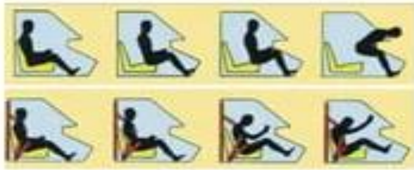
Slika 15. Sigurnosni pojas s tri točke vezanja
