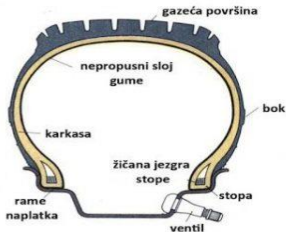
Slika 7. Poprečni presjek radijalnog pneumatika
