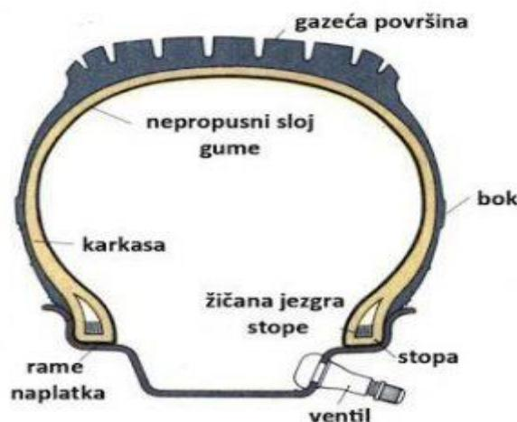
*Slika 7. Poprečni presjek radijalnog pneumatika*
