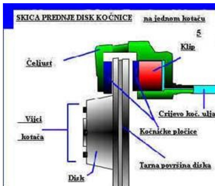
Slika 1. Koćenje pomoću diska
