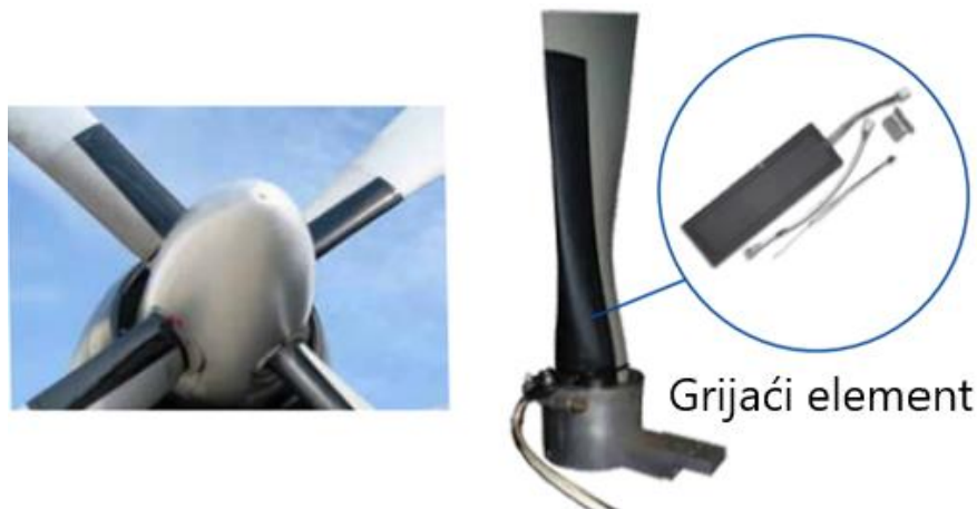
Slika 3. Propeler s grijalicama
