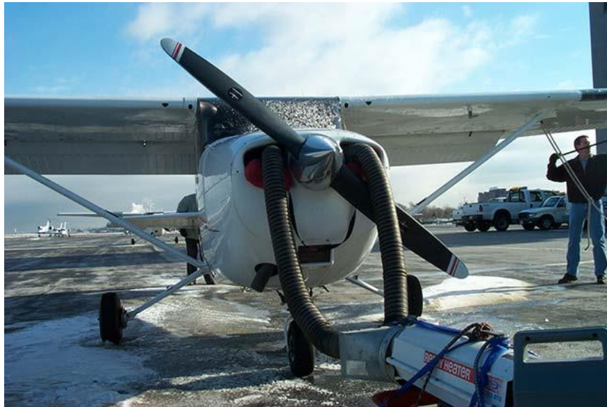
Slika 9. Odleđivanje motora vrućim zrakom
