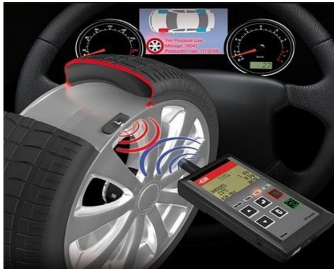
Tablica 15: Sustav za nadzor tlaka u gumama
