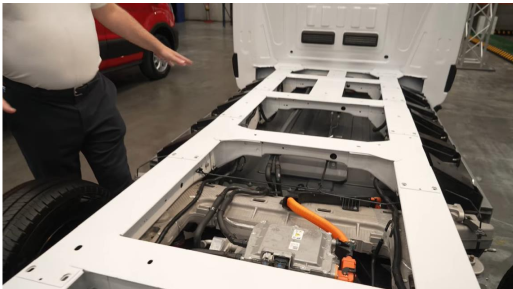
Slika 25. Pogonski sklop Ford E-Transita
