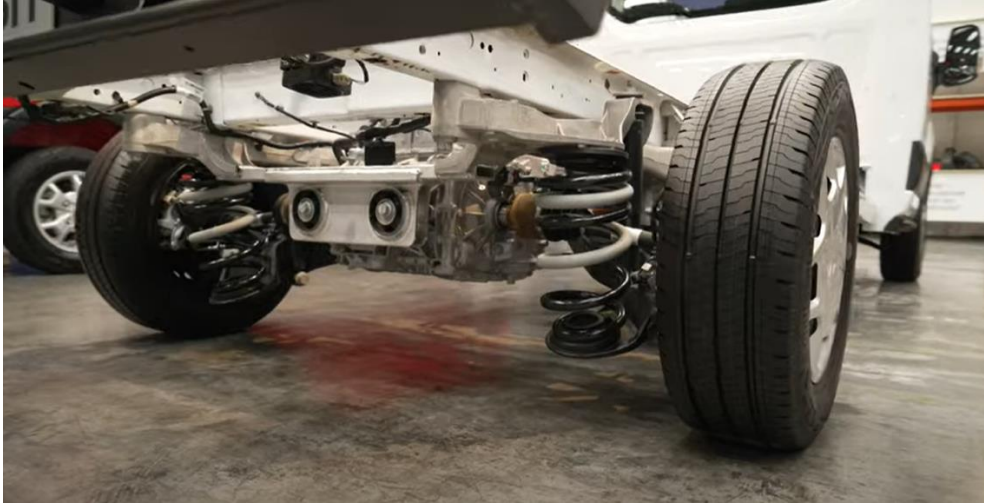
Slika 26. Nezavisni ovjes Ford E-Transita
