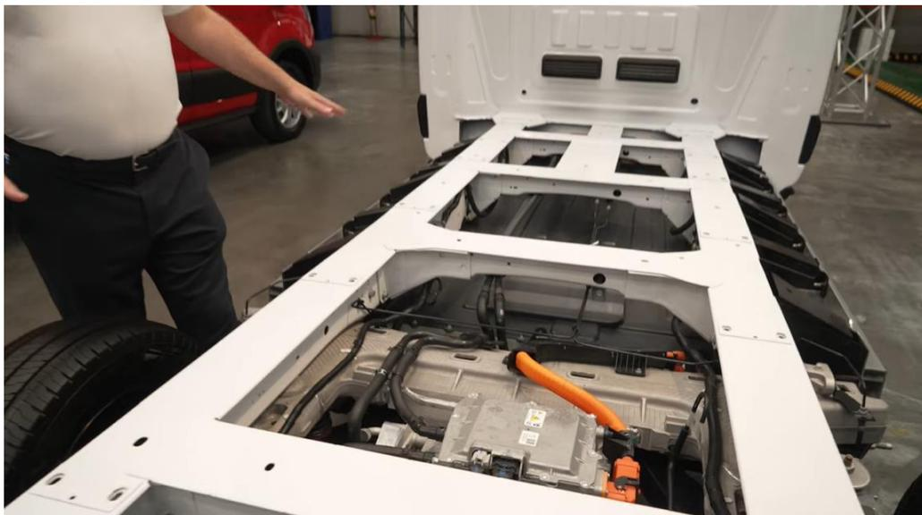
*Slika 25. Pogonski sklop Ford E-Transita*
