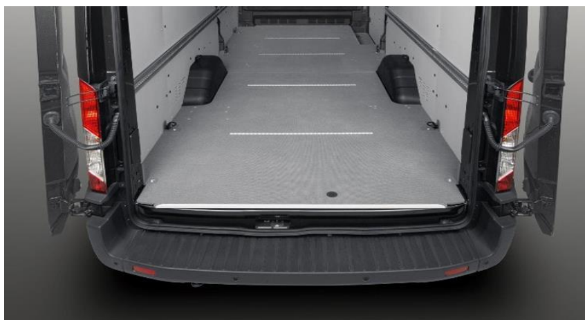
Slika 15. Utovarni prag na stražnjem braniku Ford Transita
